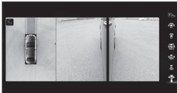
Wenn die elektrische Verbindung vom Fahrzeug zum Anhänger hergestellt wird, wechselt die Anzeige zu einer Ansicht der Seitenkameras.
