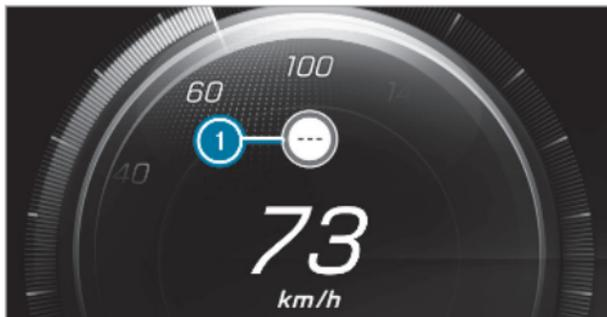
Der Geschwindigkeitslimit-Assistent ist nicht in allen Ländern verfügbar. Falls er nicht verfügbar ist, erscheint die Anzeige ❶ im Tachometer.
