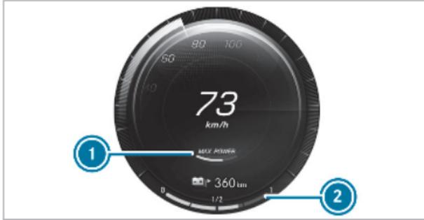
Die Anzeige ❶ zeigt die maximal verfügbare Leistung des Antriebssystems an.
