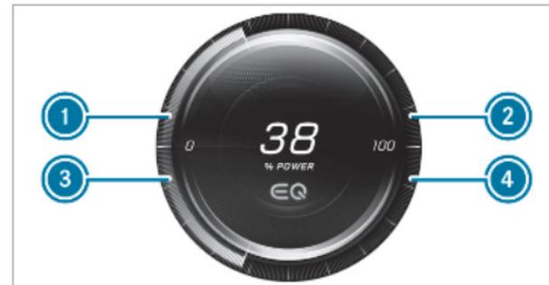
Der Bereich **❶** - **❷** zeigt die Antriebsleistung. Der Bereich **❸** - **❹** zeigt die zurückgewonnene Leistung.
