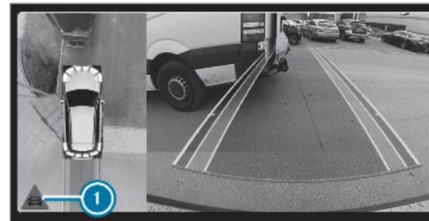
**Fahrzeuge mit Totwinkel-Assistent:** Die Funktion Cross Traffic Alert kann beim Ausparken in Rückwärtsrichtung vor querendem Verkehr warnen. Dazu überwachen die Radarsensoren im Stoßfänger den an das Fahrzeug angrenzenden
