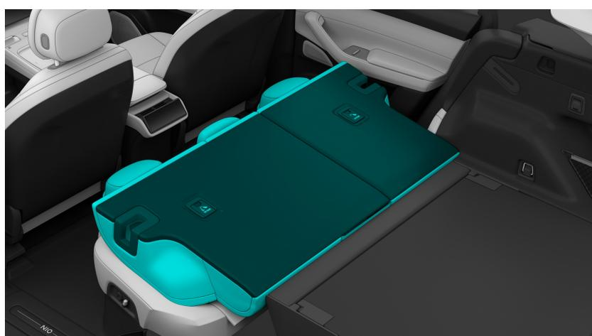
Ziehen Sie am mechanischen Griff der Rückenlehne und drücken Sie die Lehne nach vorne, um sie umzuklappen.
