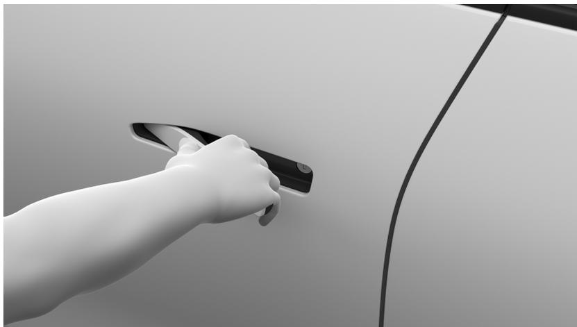
Der Türaußengriff wird automatisch eingezogen, wenn das Fahrzeug verriegelt ist oder schneller als 8 km/h gefahren wird.
