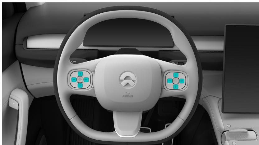
Öffnen Sie unten im Center-Display die Einstellungen, tippen Sie auf **Position einstellen** > **Außenspiegel einstellen** > **Start**, passen Sie die Position mit den Tasten am Lenkrad an und tippen Sie zum Abschluss auf **Ende**. Alternativ können Sie auf der Startseite des Center-Displays von links nach rechts wischen, um die Schnelleinstellungen zu öffnen, und dann auf **Außenspiegel einstellen** > **Start** tippen.
