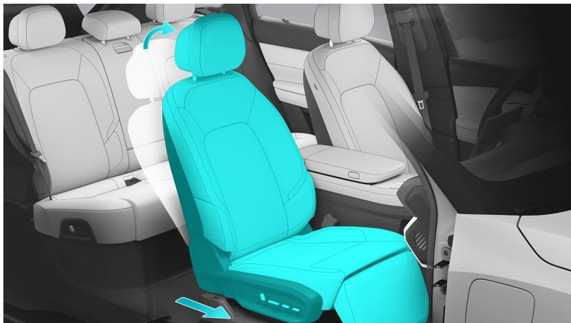
Sie können unten auf dem Center-Display auf die Einstellungen zugreifen und auf **Position einstellen > Beifahrersitz > Einstiegshilfe für die Beifahrerseite** tippen, um diese Funktion zu aktivieren oder zu deaktivieren. Für die Einstiegshilfe für die Beifahrerseite gibt es zwei Einstellungsoptionen:
