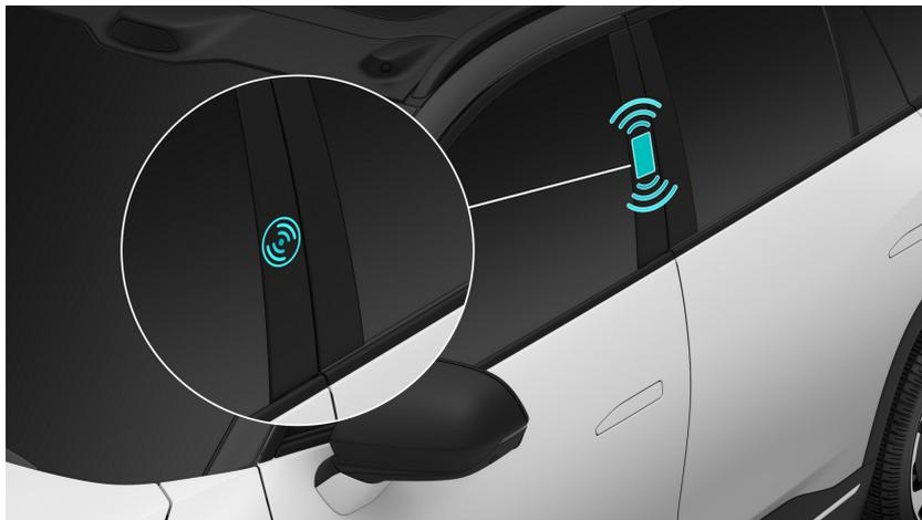
Legen Sie die NFC-Karte in die Nähe des NFC-Erkennungsbereichs an der fahrerseitigen B-Säule und halten Sie sie eine Weile, um das Fahrzeug automatisch ent- oder verriegeln zu lassen. Nach erfolgreicher Entriegelung werden die Türgriffe automatisch angehoben. Nach erfolgreicher Verriegelung werden die Türgriffe automatisch mit Abgabe eines Verriegelungsgeräuschs eingezogen.
