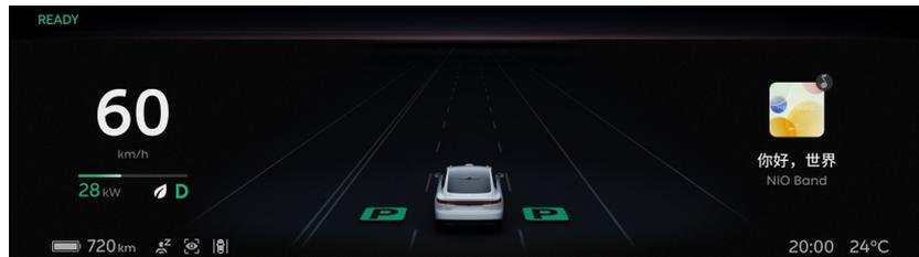
Wenn die Dual-View-Ansicht „Einparken abgeschlossen“ anzeigt und die Hintergrundfarbe des Buchstabens „P“ auf beiden Seiten des Symbols „Mein Fahrzeug“ auf dem digitalen Kombiinstrument grün wird, bedeutet dies, dass das Einparken abgeschlossen ist.
