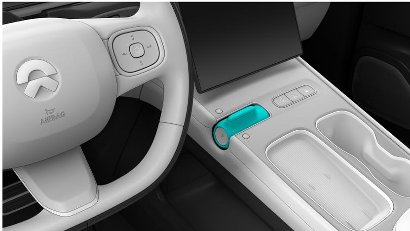
Verwenden Sie den Wählhebel in der Mittelkonsole um in den gewünschten Gang zu schalten:
