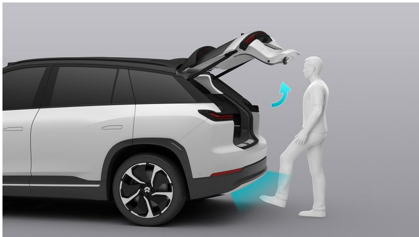
Um die Heckklappe mit einer Trittbewegung zu öffnen, bewegen Sie den Fuß unter der Mitte des Heckstoßfängers schnell (mindestens 10 cm) hin und her oder führen Sie eine horizontale Trittbewegung mit einer Amplitude von mindestens 10 cm unter dem Heckstoßfänger aus.
