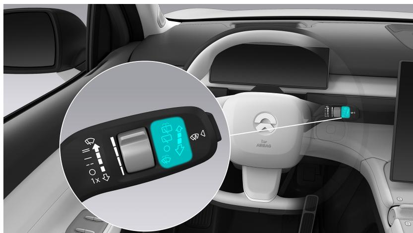
Ziehen Sie den rechten Lenkstockhebel in Richtung Fahrergesicht und wählen Sie
