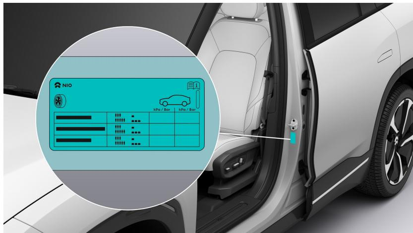
Zu hoher Reifendruck wirkt sich auf Ihren Komfort während des Fahrens aus, führt zu Reifenschäden, insbesondere auf unebenen Straßen, und verursacht Reifenplatzer in schweren Fällen. Dies kann unerwarteten Verlust der Fahrzeugkontrolle und erhöhte Verletzungsgefahr zur Folge haben. Zu niedriger Reifenfülldruck verursacht ungleichmäßigen Reifenverschleiß, beeinträchtigt die Fahrzeughandhabung und führt zu anormalem Energieverbrauch.
