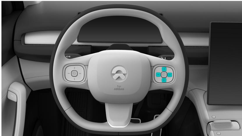
Öffnen Sie zum Einstellen der Außenspiegel unten im Center-Display die Einstellungen, tippen Sie auf **Position einstellen > Lenkrad einstellen > Start**, stellen Sie die Position mit den Tasten rechts am Lenkrad ein und tippen Sie nach Abschluss der Einstellung auf **Ende**. Alternativ können Sie auf der Startseite im Center-Display nach rechts wischen, um die Schnelleinstellungen zu öffnen, und auf **Lenkrad einstellen > Start** tippen.
