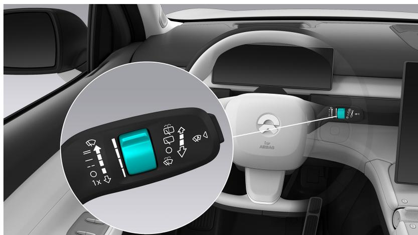
Wenn das Intervallwischen aktiviert ist, können Sie die Geschwindigkeit über den Regler am Hebel einstellen. Drehen Sie den Regler nach oben, um die Wischgeschwindigkeit zu erhöhen, und nach unten, um die Wischgeschwindigkeit zu reduzieren.
