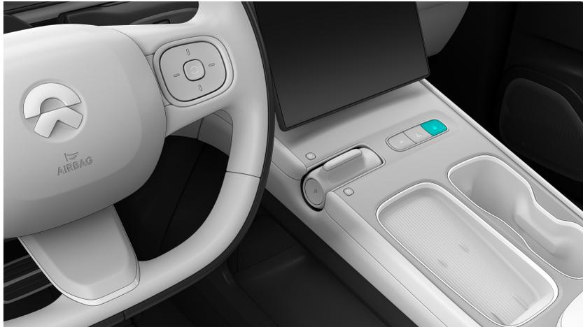
Wenn das Fahrzeug entriegelt ist und alle Türen geschlossen sind, können Sie es von innen per Druck auf die Zentralverriegelung verriegeln. Nach dem Verriegeln erscheint im Center-Display ein **Fahrzeug verriegelt**-Symbol. Zugleich leuchtet die LED der Taste grün.
