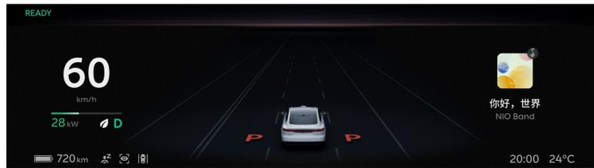
Wenn der Schaltfreie Erweiterte Parkassistent mit Fusion unbeabsichtigt deaktiviert wird, wird der Buchstabe „P“ auf der linken oder rechten Seite des Symbols „Mein Fahrzeug“ auf dem digitalen Kombiinstrument rot angezeigt.
