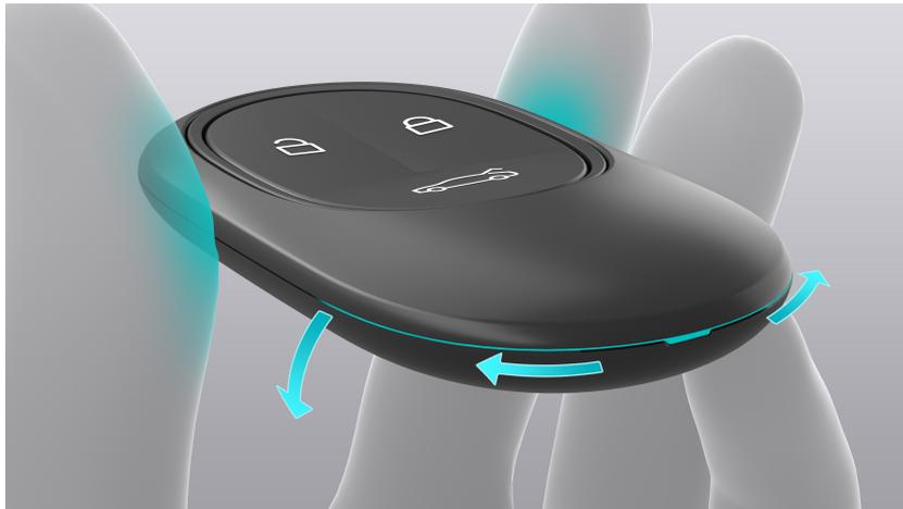
Setzen Sie die Knopfzelle mit dem Pluspol nach unten ein. Richten Sie nach dem Einsetzen die Batteriekontakte aus und schließen Sie danach den hinteren Deckel korrekt, um den einwandfreien Gebrauch der Smart Key-Fernbedienung zu gewährleisten.
