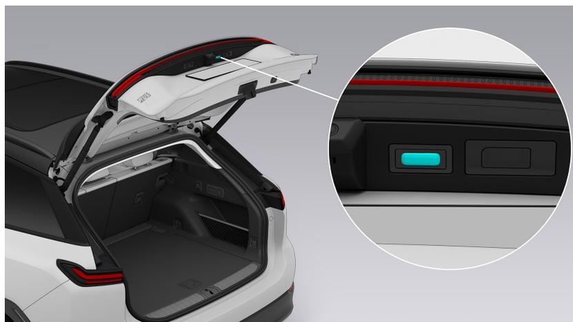
Wenn Sie einen Funkschlüssel bei sich tragen, können Sie die Heckklappe durch leichtes Drücken der Taste am Heckklappengriff öffnen.
