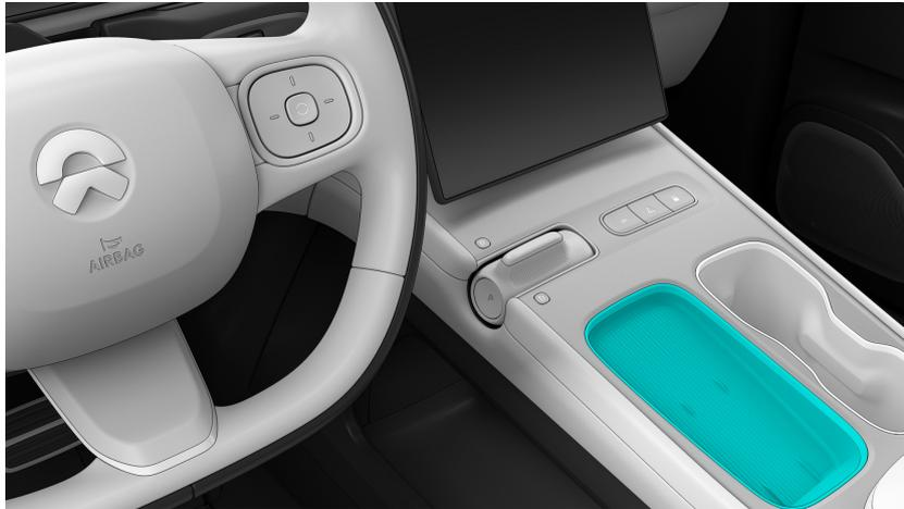
Die Funktion für das kabellose Laden ist standardmäßig aktiviert. Öffnen Sie unten im Center-Display die Einstellungen und tippen Sie auf **Verbinden > Kabelloses Laden**, um die Funktion auszuschalten. Die aktuelle Einstellung wird im Konto des Fahrzeugeigentümers oder befugten Benutzers gespeichert. Der aktuelle Ladestatus wird am Center-Display angezeigt.
