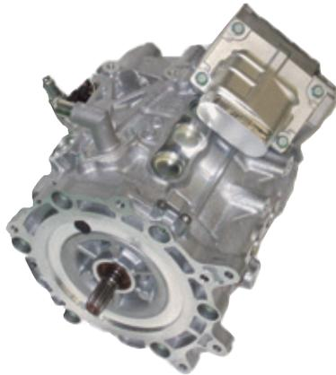
Der in der Li-Ion-Batterie gespeicherte Gleichstrom wird vom Wechselrichter des Traktionsmotors in Dreiphasen-Wechselstrom umgewandelt. Die elektrische Energie wird dazu genutzt den Motor anzutreiben, um Antriebsenergie zu erhalten. Durch die Phasenumkehr des Dreiphasenstroms wird die Drehrichtung des Motors umgekehrt. Anhand dieser Eigenschaft kann das Fahrzeug von der Fahrstufe D in den Rückwärtsgang R geschaltet werden.
