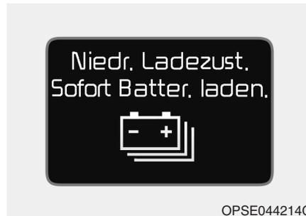
Wenn der Ladezustand der Hochvoltbatterie weniger als 10% beträgt, leuchtet diese Warnmeldung auf. In diesem Fall leuchtet gleichzeitig die Warnleuchte (🔋) im Kombiinstrument auf und die Reichweite wird als "----" angezeigt. Laden Sie die Hochvoltbatterie umgehend auf.
