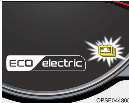
1. Wenn 4 Balken auf der Hochvolt-Ladezustandsanzeige angezeigt werden (fast "MIN"), leuchtet die Warnleuchte auf, um auf den Batterieladezustand hinzuweisen.
