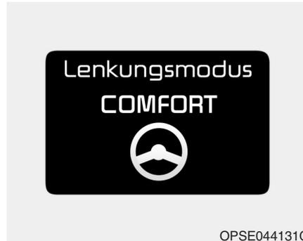
Der Lenkeraufwand nimmt ab. Der Komfortmodus kommt normalerweise im Stadtverkehr oder beim Einparken zum Einsatz.
