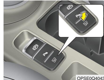
Das Soul Elektrofahrzeug verfügt über eine ECO-Funktion zur Optimierung des Energieverbrauchs.
