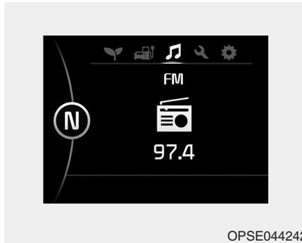
In dieser Betriebsart wird der Zustand des A/V-Systems angezeigt.
