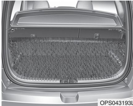
Um zu verhindern, dass sich das Ladegut unkontrolliert im Laderaum umherbewegen kann, können Sie die 4 Halter im Laderaum für die Befestigung eines Gepäcknetzes verwenden.
