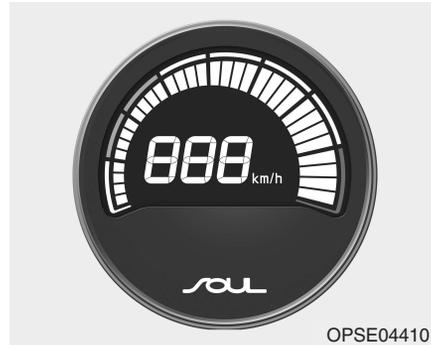
Der Tachometer zeigt die Fahrgeschwindigkeit in Meilen pro Stunde (mph) und/oder in Kilometer pro Stunde (km/h) an.
