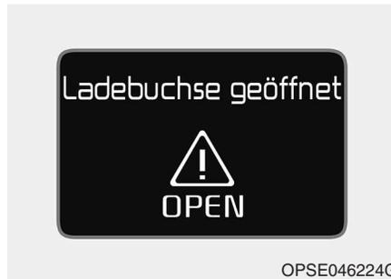
Wenn das Fahrzeug bei geöffneter Ladeklappe gestartet wird, erscheint diese Warnmeldung. Achten Sie darauf, nach dem Ladevorgang die Ladeklappe zu schließen.
