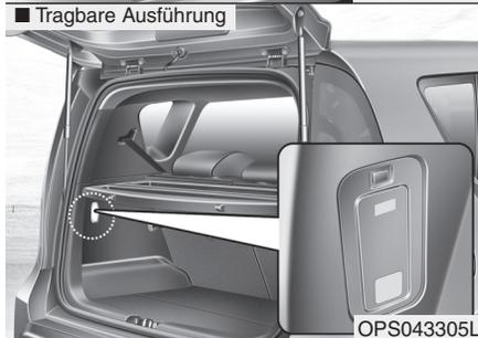
Die Laderaumleuchte leuchtet auf, wenn die Heckklappe geöffnet wird.
