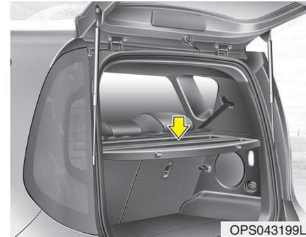
Mit der Laderaumabdeckung kann der Laderaum abgedeckt werden, um die darin befindlichen Dinge vor fremden Blicken zu schützen.
