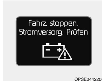
Diese Warnmeldung leuchtet auf, wenn die Energiezufuhr gestört ist. Halten Sie das Fahrzeug in diesem Fall an einer sicheren Stelle an. Ferner empfehlen wir, das Fahrzeug in einer Kia Vertragswerkstatt inspizieren zu lassen.
