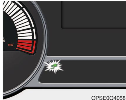
8. Vergewissern Sie sich, dass die Hochvoltbatterie-Ladekontrollleuchte im Instrumentenblock aufleuchtet.
