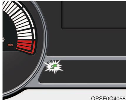
10. Vergewissern Sie sich, dass die Hochvoltbatterie-Ladekontrollleuchte im Instrumentenblock aufleuchtet. Wenn die Ladekontrollleuchte nicht leuchtet, wird nicht geladen. Wenn Ladestecker und Ladeschnittstelle nicht ordnungsgemäß miteinander verbunden sind, schließen Sie das Ladekabel erneut an.
