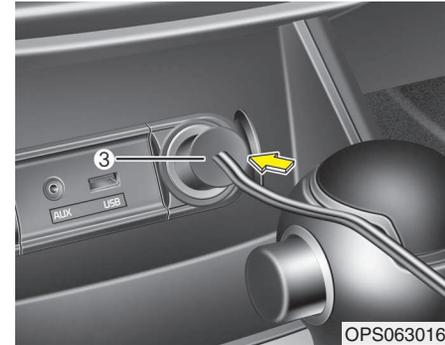
7. Schließen Sie das Stromkabel des Kompressors an die Steckdose (180 W) auf der Beifahrerseite an.
