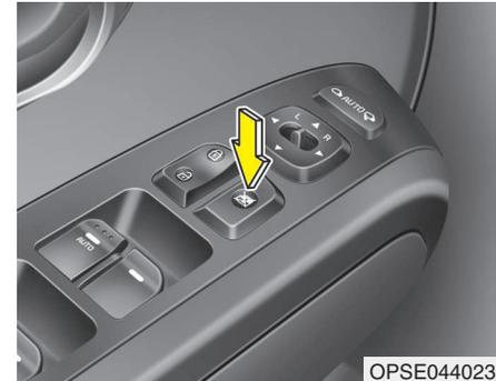
Der Fahrer kann die elektrischen Fensterheber der hinteren Türen deaktivieren, indem er die Fensterhebersperrtaste in die Stellung "gesperrt" bringt (Taste gedrückt).
