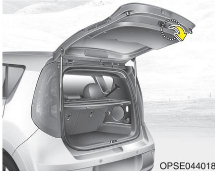
Um die Heckklappe zu schließen, senken Sie die Heckklappe und drücken Sie sie kräftig nach unten. Vergewissern Sie sich, dass die Heckklappe vollständig im Schloss eingerastet ist.
