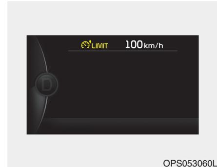
Die eingestellte Höchstgeschwindigkeit wird angezeigt.
