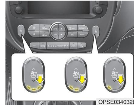
Die Belüftung dient der Kühlung des Fahrersitzes bei heißem Wetter. Sie funktioniert, indem Luft durch winzige Löcher in den Bezügen des Sitzpolsters und der Rückenlehne geblasen wird.
