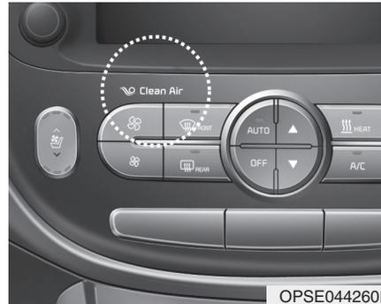
Wenn sich die POWER-Taste in der Stellung ON (Ein) befindet, wird automatisch die Reinluftfunktion aktiviert. Analog dazu wird die Reinluftfunktion automatisch deaktiviert, wenn die POWER-Taste in die Stellung OFF (Aus) gedrückt wird.
