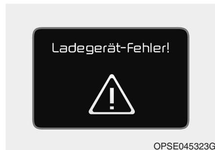
Diese Meldung erscheint, wenn das Laden aufgrund einer Störung des normalen externen Ladegeräts fehlschlägt.
