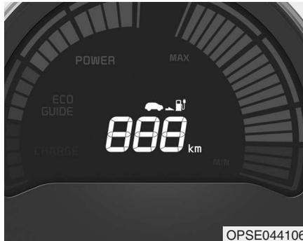
Die durchschnittliche Reichweite des Fahrzeugs beträgt ca. 148 km. Unter bestimmten Umständen (zum Beispiel bei eingeschalteter Klimaanlage) kann sich die Reichweite verringern. Daraus ergeben sich mögliche Reichweiten von 100-230 km. Bei eingeschalteter Heizung oder hoher Fahrgeschwindigkeit zieht das Fahrzeug deutlich mehr Strom aus der Hochvoltbatterie. Dies kann die Reichweite erheblich verringern.
