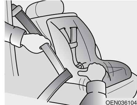
3. Schließen Sie den Sicherheitsgurt, so dass der Gurt straff an oder in dem Rückhaltesystem sitzt. Versuchen Sie nach dem Befestigen, den Kindersitz in alle Richtungen zu bewegen, um sicherzustellen, dass das Kinderrückhaltesystem sicher befestigt ist.
