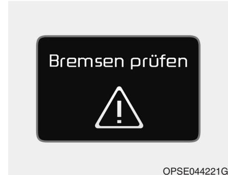
Diese Warnmeldung leuchtet auf, wenn die Bremsleistung schwach ist oder die Bremsenergieerückgewinnung aufgrund einer Störung der Bremsanlage nicht ordnungsgemäß funktioniert. In diesem Fall spricht das Bremspedal möglicherweise verzögert an und es verlängert sich möglicherweise der Bremsweg.
