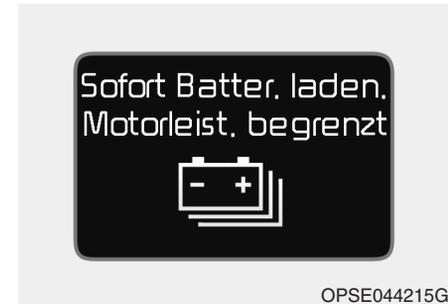
Wenn der Ladezustand der Hochvoltbatterie weniger als 7% beträgt, leuchtet diese Warnmeldung auf. In diesem Fall leuchten gleichzeitig die Warnleuchte (🔋) im Kombiinstrument und die Abschaltwarnleuchte (🚫) auf und die Reichweite wird als "----" angezeigt. Die Leistung des Fahrzeugs wird gedrosselt, um den Verbrauch von Energie aus der Hochvoltbatterie zu verringern. Laden Sie die Batterie umgehend auf.
