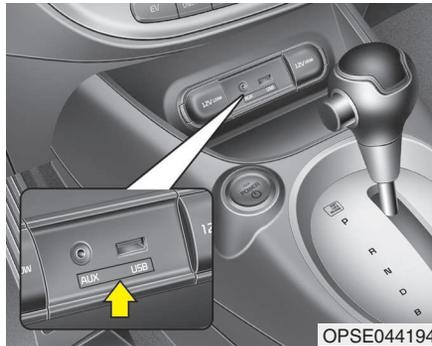
Wenn Ihr Fahrzeug mit einer AUX- und/oder USB-Schnittstelle (USB: Universal Serial Bus) oder einer iPod®-Schnittstelle ausgestattet ist, können Sie Audiogeräte bzw. USB-Datenträger bzw. einen iPod® daran anschließen.
