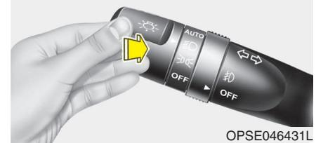
Um das Fernlicht einzuschalten, drücken Sie den Lichtschalterhebel nach vorn. Ziehen Sie den Hebel zurück, um das Abblendlicht wieder einzuschalten. Die Fernlicht-Kontrollleuchte leuchtet bei eingeschaltetem Fernlicht auf. Um zu verhindern, dass die Batterie entladen wird, lassen Sie die Scheinwerfer nicht über einen längeren Zeitraum eingeschaltet, wenn sich das Fahrzeug nicht im Bereitschaftsmodus (🚗) befindet.
