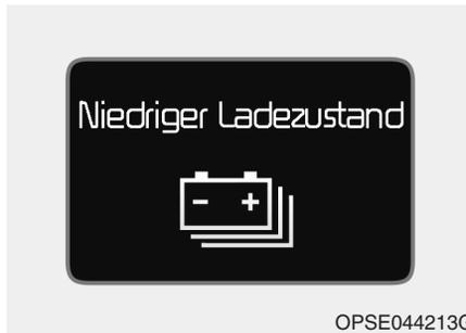
Wenn der Ladezustand der Hochvoltbatterie weniger als 20 % beträgt, leuchtet diese Warnmeldung auf. In diesem Fall leuchtet gleichzeitig die Warnleuchte (🔋) im Kombiinstrument auf. Laden Sie die Hochvoltbatterie umgehend auf.
