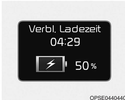
11. Nachdem der Ladevorgang begonnen hat, wird etwa 1 Minute lang die voraussichtliche Ladezeit auf dem Instrumentenblock angezeigt. Wenn Sie während des Ladevorgangs die Fahrertür öffnen, wird ebenfalls etwa 1 Minute lang die voraussichtliche Ladezeit auf dem Instrumentenblock angezeigt. Wenn ein Ladezyklus programmiert wurde, wird die voraussichtliche Ladezeit wie folgt angezeigt: "--".
