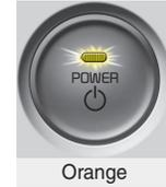
Drücken Sie, ohne das Bremspedal zu treten, die POWER-Taste, während sie sich in der Stellung OFF (AUS) befindet. Daraufhin wird die Lenkradsperre aufgehoben und elektrisches Zubehör ist funktionsbereit. Wenn sich die POWER-Taste mehr als 1 Stunde lang in der Stellung ACC befindet, findet eine automatische Abschaltung statt, um das Entladen der Batterie zu verhindern.
