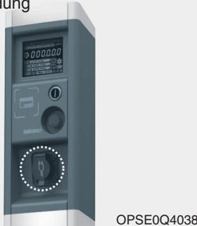
9. Verbinden Sie das andere Ende des Ladekabels mit dem Auslass eines normalen Ladegeräts, um mit dem Laden zu beginnen.
