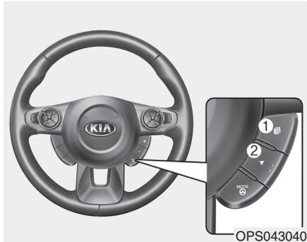
Die Betriebsarten des LCD-Displays lassen sich mit den Lenkradtasten ändern.
