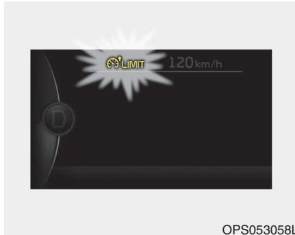
Die Anzeige der Höchstgeschwindigkeit im Kombiinstrument leuchtet danach auf.
