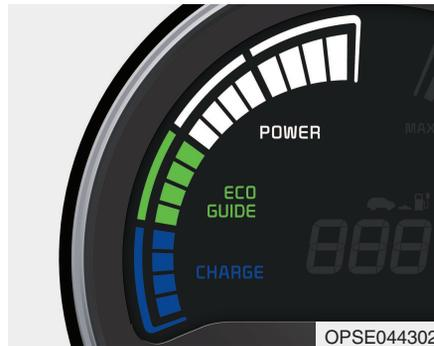
Gibt Aufschluss über den Energieverbrauch des Fahrzeugs und den Lade-/Entladezustand der Bremsenergieerückgewinnung.
