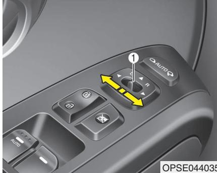
Der Schalter für die elektrische Spiegeleinstellung ermöglicht es Ihnen, den linken und rechten Außenspiegel einzustellen.
