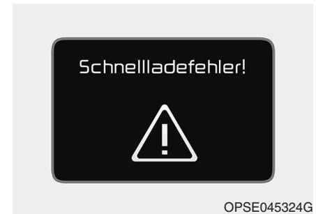
Diese Meldung erscheint, wenn das Laden aufgrund einer Störung des externen Schnellladegeräts fehlschlägt.
