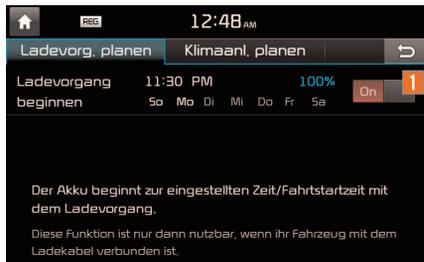
Die Einstellung wird gespeichert und die Einstelldaten werden auf dem Display angezeigt.
