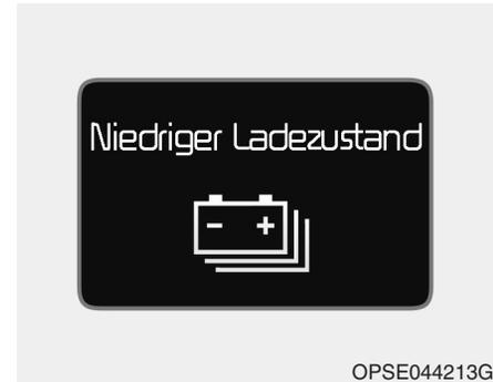
Wenn der Ladezustand der Hochvoltbatterie weniger als 20 % beträgt, leuchtet diese Warnmeldung auf. In diesem Fall leuchtet gleichzeitig die Warnleuchte (⚠️) im Kombiinstrument auf. Laden Sie die Hochvoltbatterie umgehend auf.
