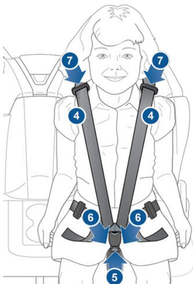
Um den Gurt zu öffnen, drücken Sie den Knopf am Schloß, und trennen Sie die beiden Hälften des Rückhaltesystems.
