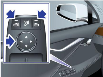
Drücken Sie auf die mittlere Taste, um die Außenspiegel ein- und auszuklappen. Wenn die Spiegel beim Verriegeln von Model S automatisch eingeklappt werden sollen, wählen Sie **Fahrzeug > Einstellungen > Bedienung > Automatisch einklappen > AN**. Die Spiegel werden automatisch ausgeklappt, wenn Model S entriegelt wird.
