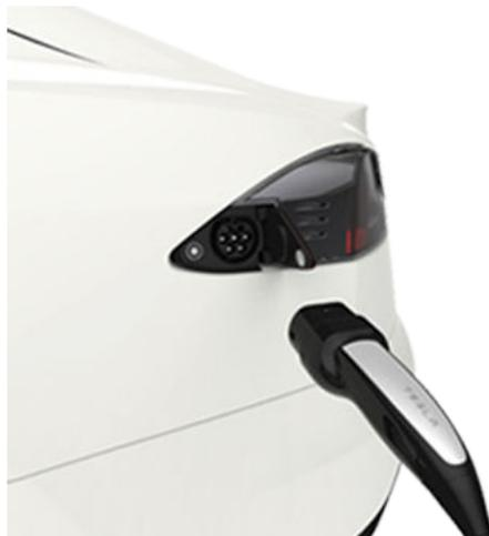
**Hinweis:** Die Leuchten am Ladeanschluss beginnen weiß zu leuchten, wenn Sie den Verschlussdeckel des Ladeanschlusses öffnen. Wenn innerhalb weniger Minuten nach dem Öffnen des Verschlussdeckels kein Ladekabel am Ladeanschluss angeschlossen wird, so schliesst der Verschlussdeckel wieder. Wenn dies geschieht, öffnen Sie den Verschlussdeckel des Ladeanschlusses erneut über den Touchscreen
