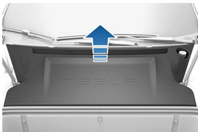
**⚠️ Vorsicht:** Die Wartungsklappe schützt den vorderen Kofferraum vor eindringendem Wasser. Achten Sie beim Wiedereinbau darauf, dass sie richtig sitzt.
