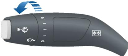
Drücken Sie kurz auf das Ende des Hebels, um den Wischer nur ein einziges Mal zu bedienen.
