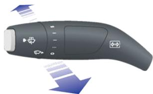
Die auf Fernlicht gestellten Scheinwerfer können automatisch abblenden, sobald eine Lichtquelle vor Model S erkannt wird (z. B. ein entgegenkommendes Fahrzeug). Um diese Funktion zu aktivieren, drücken Sie auf **Fahrzeug > Abblendassistent**.
