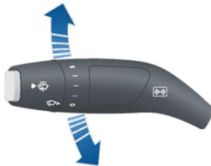
Die Blinker hören auf zu blinken, wenn sie je nach Position des Lenkrads das entsprechende Signal erhalten oder wenn Sie den Hebel wieder in mittiger Position einrasten lassen.
