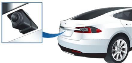
Immer, wenn Sie in den Rückwärtsgang schalten, wird auf dem Touchscreen das Bild von dieser Kamera angezeigt. Ihre Fahrstrecke wird basierend auf der Position des Lenkrads durch Linien angezeigt. Diese Linien passen sich bei Bewegung des Lenkrads entsprechend an.
