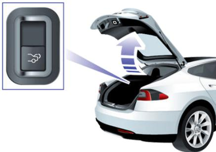
Wenn Model S mit der elektrischen Heckklappe ausgestattet ist, müssen Sie die Heckklappe nicht nach oben drücken. Wenn Sie den Öffnungsschalter drücken, wird der Kofferraum geöffnet. Wenn Sie am Schalter ziehen, wird er geschlossen.
